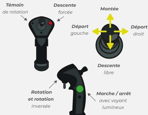
Le distributeur à commandes électro-hydrauliques est livré avec un manipulateur ergonomique.
