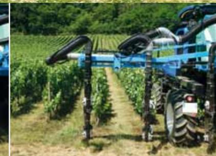
Les rampes Extensive sont dotées d'un système télescopique hydromécanique qui combine un mouvement de coulissement hydraulique au déplacement mécanique d'un chariot. Cette conception unique permet un fonctionnement à la fois simple, précis et rapide :
