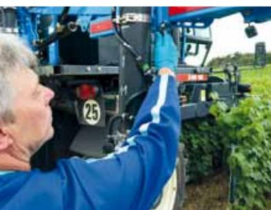
Des poignées de serrage rapide permettent de réaliser l'opération rapidement et sans outil.
