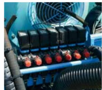
La coupure des tronçons est réalisée au moyen de vannes électriques à clapet (VEC) qui sont reliées à un circuit de décharge. Lorsque l'on ferme une section de rampe, la pression chute instantanément dans le tronçon concerné entraînant la coupure immédiate de la pulvérisation.
