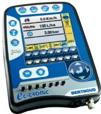
Issue du savoir-faire Berthoud (électronique Berthoud, technologie Bus Can), EC Tronic, c'est à la fois une régulation DPAE (débit proportionnel à la vitesse d'avancement électronique) précise et facile d'utilisation et une assistance efficace à la pulvérisation.
